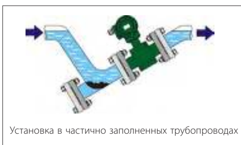
Расходомер устанавливается электронным блоком ВВЕРХ
